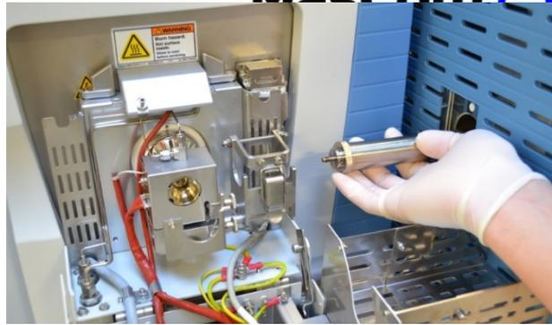
**Image 9** : Connexion de la ligne de transfert à la source APPI
