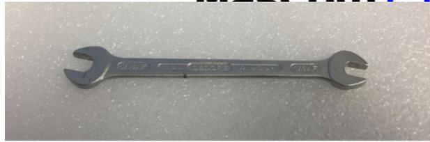
**Image C** : clef de 5/16 pour la connexion de gaz dopant
