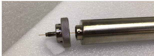
**Image 10** : ligne de transfert avec connecteur
