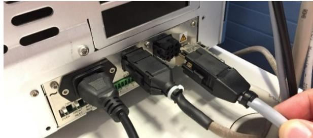
**Image 23** : connexion de chauffage de source APPI sur Trace 1310 GC
