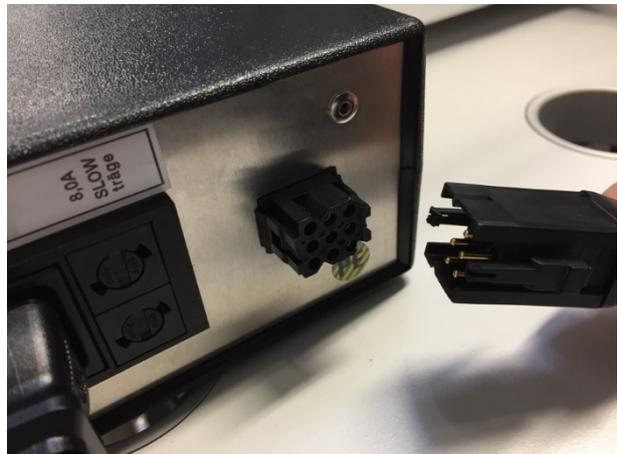
**Image 24** : connexion de chauffage de source APPI à l'alimentation en courant extérieure
