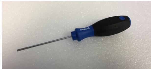
**Image B** : tournevis pour enlever le cône pulvérisateur et pour serrer la prise sur la lampe APPI
