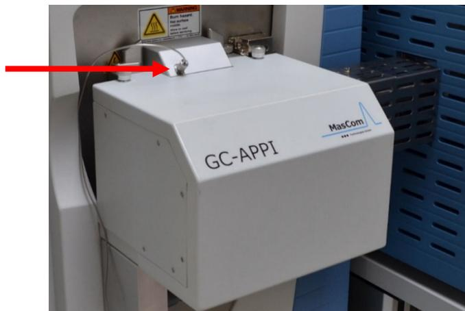
**Image 22** : Interface APPI fermé avec ligne de gaz dopant connecté
