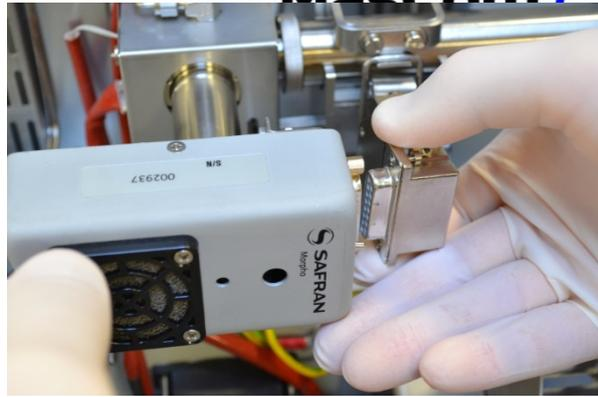
**Image 20** : connexion du câble de lampe APPI
