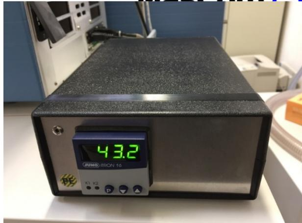
**Image 32 :** alimentation électrique extérieure pour le chauffage de source APPI
