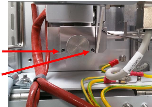
**Image 36** vis Allen pour ajustement d'interface
