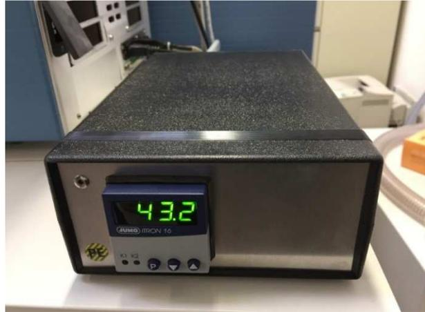
**Figura 32:** Suministro de energía externo para el calentador de la fuente APPI
