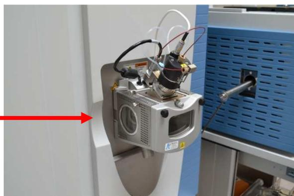
**Figura 2:** Instrumento con sprayer ESI
