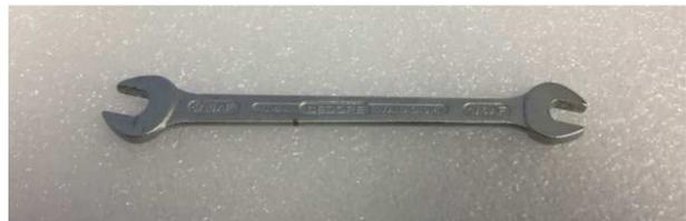
**Figura C:** Llave inglesa 5/16 para la conexión de gas dopante
