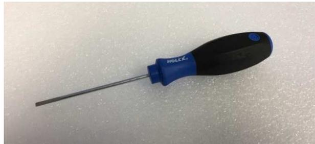
**Figura B:** Destornillador para retirar el cono de spray y para apretar el enchufe de la lámpara APPI
