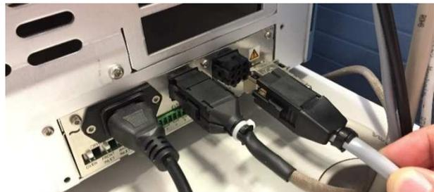
**Figura 23:** Conexión del calentador de la fuente APPI en el Trace 1310 GC
