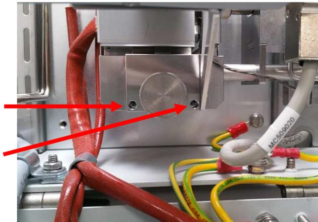
**Figura 36:** Tornillos Allen para el ajuste de la interfaz
