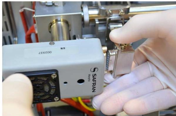
**Figura 20:** Conexión del cable de la lámpara APPI
