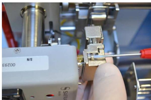
**Figura 21:** Fijación del cable APPI
