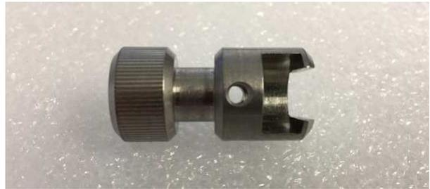
**Figura A:** Herramienta especial para retirar el tubo de transferencia
