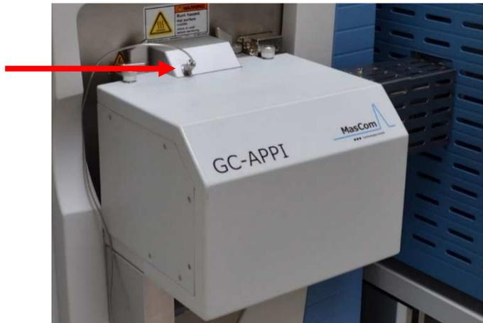
**Figura 22:** Interfaz APPI cerrada con el tubo de gas dopante conectado
