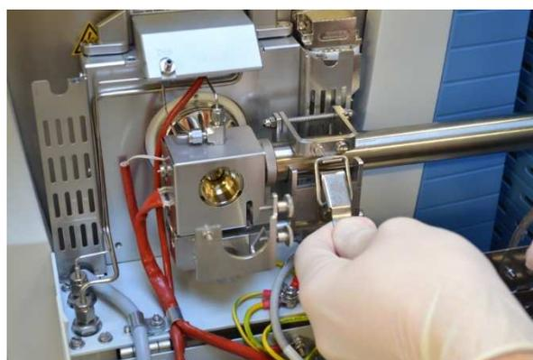
**Figura 15:** Tubo de transferencia fijado con abrazadera
