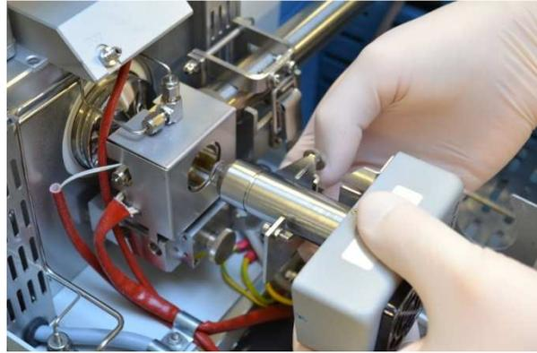
**Figura 16:** Colocación de la lámpara APPI
