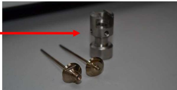
**Figura 5:** Herramienta especial para retirar el tubo de transferencia
