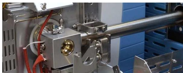
**Figura 14:** El tubo de transferencia en su posición final
