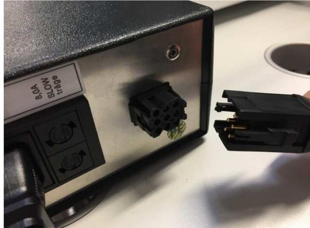
**Figura 24:** Conexión del calentador de la fuente APPI al suministro de energía externo
