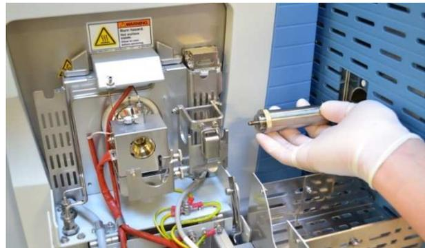
**Figura 9:** Transfiera la conexión del tubo a la fuente APPI
