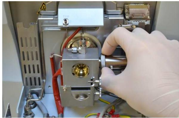
**Figura 12:** Transfiera la conexión del tubo a la fuente APPI
